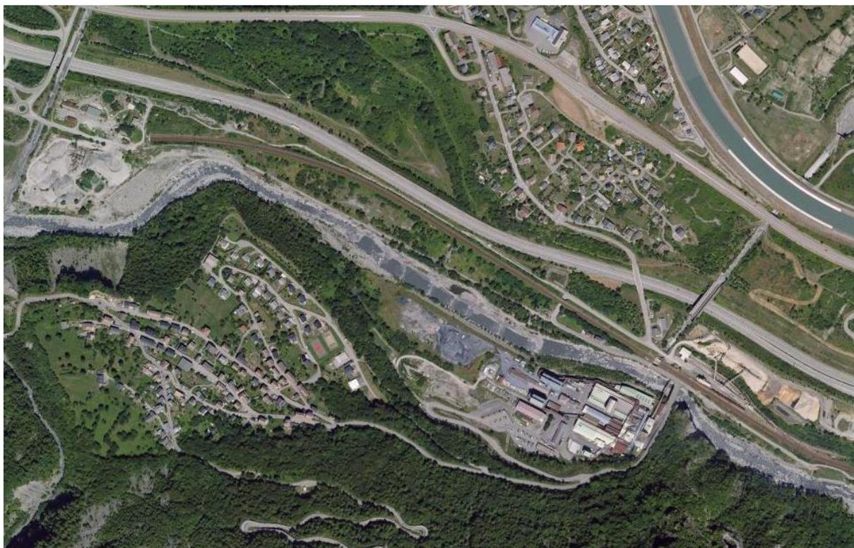
L'incision a remonté le lit de la rivière vers le seuil du Bochet. Le phénomène a été amplifié par une crue importante qui a eu lieu en 2008. Le seuil du Bochet a été détruit et l'incision est remontée jusqu'au pont des Anglais et la RD81A où le niveau du lit s'est abaissé de 3 à 4m. Suite à cette destruction, des travaux ont été réalisés en urgence par le CG73 et RFF.
